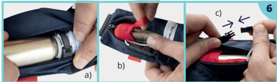
a) Halten Sie den schwarzen und weißen Kunststoffring fest. Setzen Sie eine neue Hip'Guard Gaskartusche in den Zylinder ein. **Schieben Sie die neue Gaskartusche bis zum Anschlag ein** (siehe Bild a). Wenn die Kartusche nicht ausreichend eingesetzt ist, haben Sie Schwierigkeiten, die rote Stretchkappe aufzusetzen, und der Airbag wird nicht ausreichend aufgeblasen, um einen guten Schutz zu gewährleisten.
